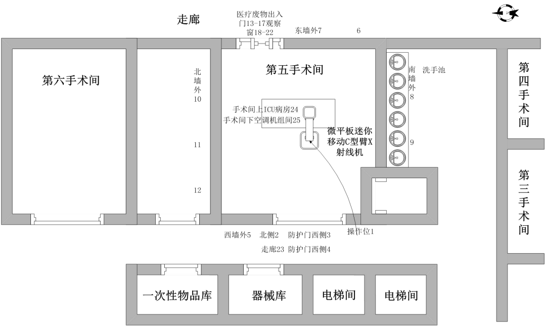
兵器工业五二一医院手术麻醉科移动C型臂X射线机放射防护检测测量点示意图
